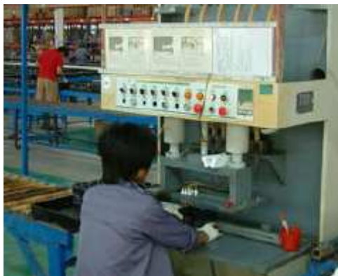
Plnění akumulátoru elektrolytem
