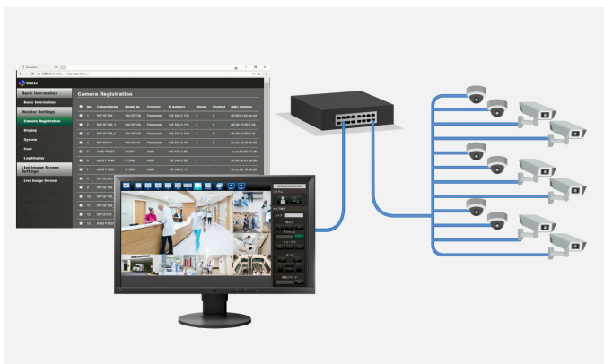
Připojení až 48 IP kamer k DuraVision FDF2711W-IP prostřednictvím síťového switchu.
